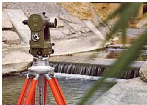
Teodolito electrónico Kern de origen suizo.
