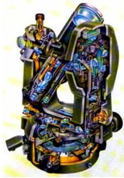
Dibujo de corte del teodolito de segundos Kern DKM2-A, mostrando los diferentes elementos que lo componen.
